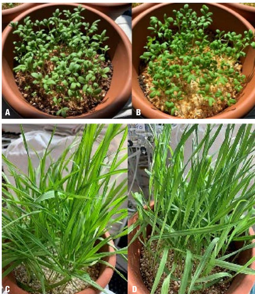
**2 Risultati dei test di ecotossicità del Technipol Bio 1160 condotti su piante di orzo (a controllo, b 50% campione) e di crescita (c controllo, d 50% campione)**
